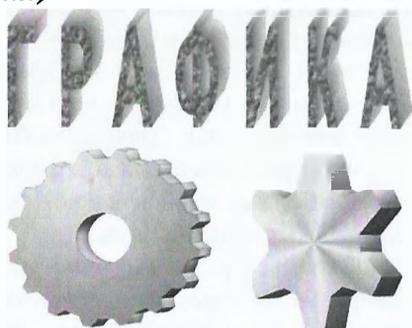
При параллельном выдавливании линии остаются параллельными, и точка схода у объекта отсутствует.
