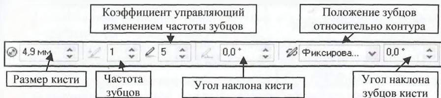
Необходимо установить указатель мыши на контур выделенного объекта и, удерживая нажатой левую кнопку мыши, двигаться вдоль контура. Контур при этом покрывается зубцами. Зубцы следуют равномерно, если коэффициент, управляющий изменением частоты зубцов, 0. При положительных значениях этого коэффициента наблюдается сгущение зубцов, при отрицательных – частота зубцов уменьшается.
